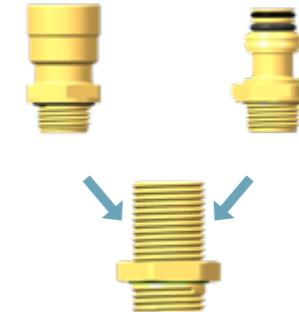
Das Einschrauben von „M“-Gewinden bei geraden ABC Steckverbinder, ABC Anschlussstutzen, und ABC Ergänzungsteilen erfolgt direkt ohne weitere Vorbehandlung in die Aufnahmegewinde gemäß DIN 3852, ISO 6149, ISO 4039-1, ISO 4039-2, Voss.
